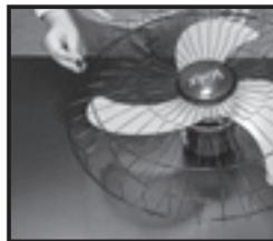
Encaixe a grade traseira (4 furos) nos parafusos do motor, observando o rebaixo da grade e a etiqueta "este lado para Baixo". Fixe a grade utilizando as arruelas de pressão 3/16" e porcas 3/16".
