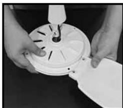
Verifique se as pás não apresentam empenamento. Fixe as pás com parafusos 3/16x30mm, arruelas de pressão e porcas de 4,75mm. **Atenção para a orientação das pás.**
