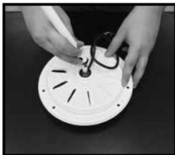
Coloque a haste com bucha de borracha no eixo do motor (a mesma deverá entrar com pressão) e verifique o alinhamento dos furos. Use a cupilha. Atravesse o furo e abra a extremidade mais longa com auxílio de um alicate.
