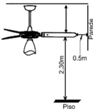
Medir a distância do teto à ponta de cada pá com o auxílio de uma régua sem retirá-la do local, gire o ventilador e verifique se as outras pás estão à mesma distância do teto. Não esquecendo de deixar pelo menos 2,30m entre o piso e as pás, e o mínimo de 0,5m entre as pás e a parede.
