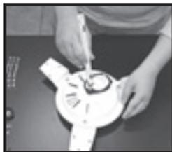
Coloque a haste com bucha de borracha no eixo do motor (a mesma deverá entrar com pressão) e verifique o alinhamento dos furos. Use a cupilha. Atravesse o furo e abra a extremidade mais longa com auxílio de um alicate.
