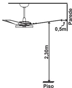
Medir a distância do teto à ponta de cada pá com o auxílio de uma régua sem retirá-la do local, gire o ventilador e verifique se as outras pás estão à mesma distância do teto. Não esquecendo de deixar pelo menos 2,30m entre o piso e as pás, e o mínimo de 0,5m entre as pás e a parede.
