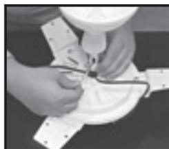
Insira o copinho e em seguida a canopla. Passe os fios pelo furo lateral inferior da haste até sair pelo furo lateral superior.
